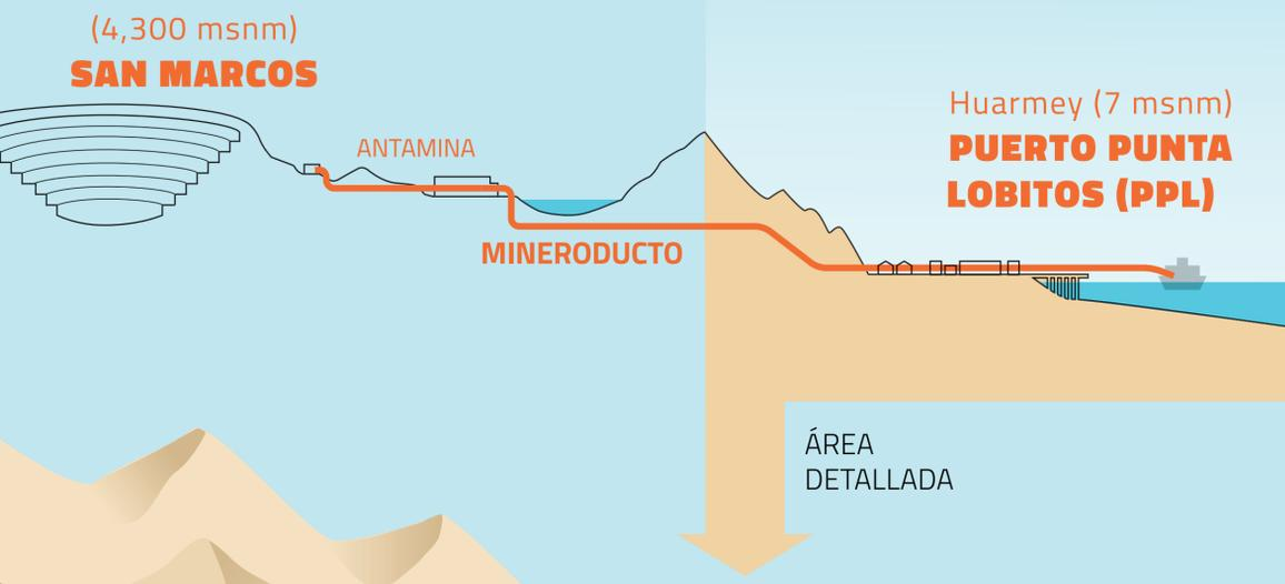
Las tuberías del mineroducto transportan el mineral bajo tierra.
